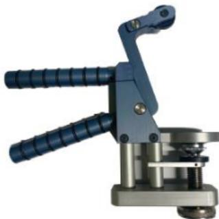
Stativ zur Prüfung kleinerer Proben
