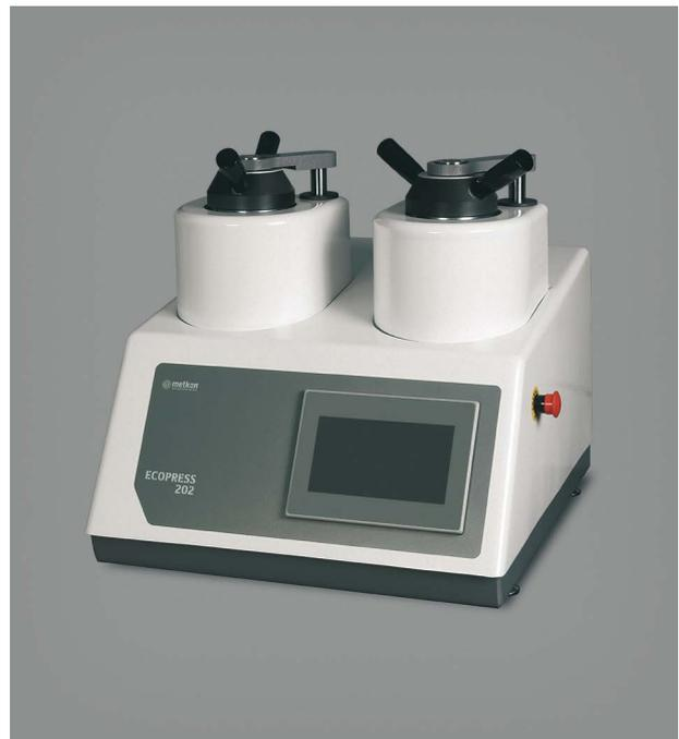
Ecopress 202, automatische Einbettpresse mit zwei Zylindern
