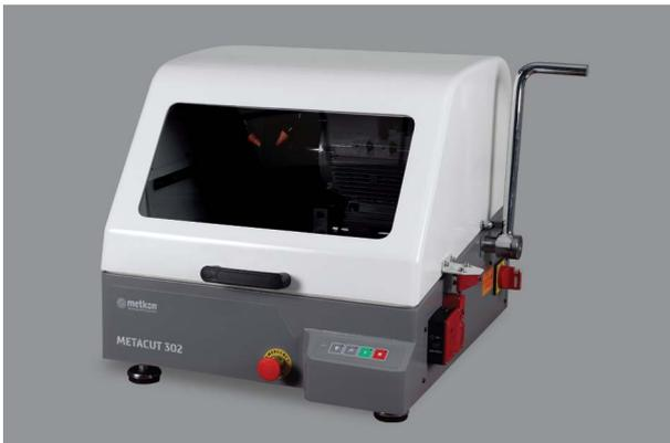
Die neue Konstruktion mit leichter Neigung des Bodens in der Schneidkammer ermöglicht ein einfaches Abfließen der Kühl-/Schneidflüssigkeit zurück zum Umlaufkühlsystem. METACUT 302 ist sowohl als Tischgerät als auch als mit optionalem Unterbauschrank erhältlich. Nur Bedientasten für START, STOP, SPÜLUNG und BELEUCHTUNG.
