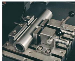
Edelstahl Spannvorrichtungen und T-Nuten-Trenntisch
